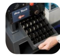
Das Ablagesystem „XY Sorter“ ermöglicht eine variable Unterteilung bis hin zu 42 Fächern.
