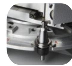
Der Werkzeugwechsellvorgang erfolgt vollautomatisch bei Mehrfachfräsprozessen innerhalb eines Schlüssels.
